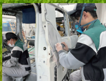
②Rフェンダーパテ付け
